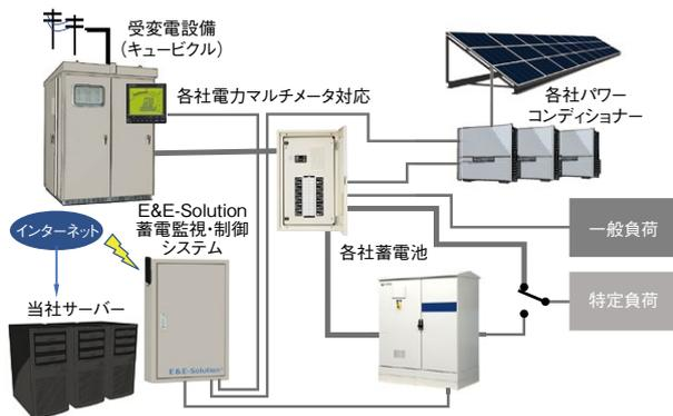
構成例 (太陽光発電・蓄電池連携 充放電制御) \*中間分電盤、接続箱等省略
